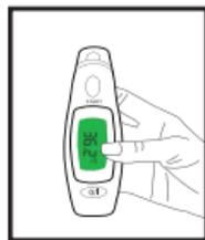
5. Appuyez une fois sur le bouton **MISE EN MARCHÉ** et relâchez-le. Déplacez l'instrument continuellement à partir de 1 cm au-dessus du centre du sourcil vers la tempe. Un long bip retentira après 3 secondes pour confirmer la fin de la prise de mesure. Si le mouvement de la sonde est trop lent à atteindre la tempe avant qu'un long bip se fasse entendre, répétez la prise de mesure décrite ci-dessus en accélérant le mouvement du déplacement de la sonde.
